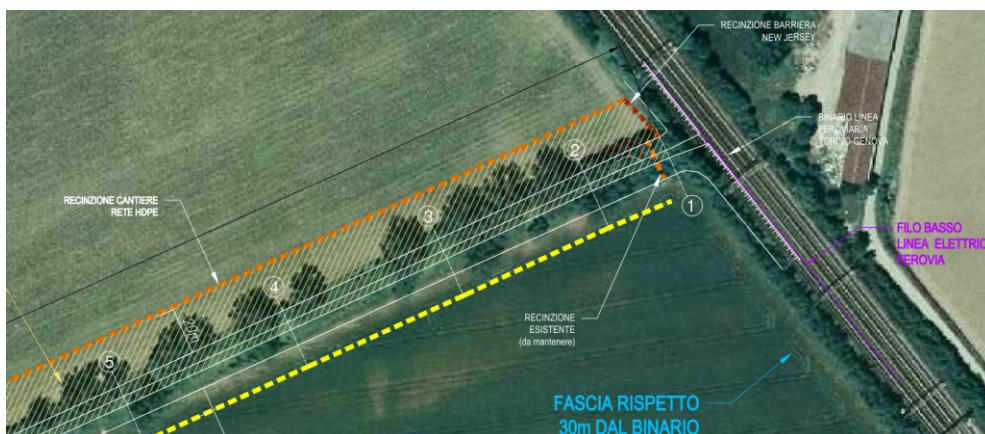
Estratto planimetria di progetto – Interferenza con fascia rispetto ferroviaria
